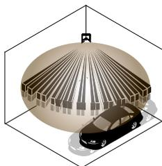
Come da esempio a lato, la macchina impegna l'area di copertura del sensore diventando così un "Ostacolo" per la rilevazione degli infrarossi, ma non della microonda che invece è in grado di attraversarlo. La funzione Blocking interviene appunto quando una persona si muove davanti alla macchina, attivando così solo la microonda e non gli infrarossi.
