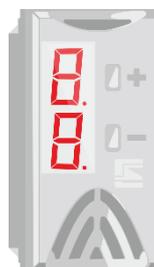
Sensore di temperatura con display, per installazione a frutto (1 posizione). Utilizzato per le funzioni di controllo "clima" (riscaldamento e raffreddamento), Thermopoint visualizza a display la temperatura dell'ambiente in cui è installato e fornisce l'andamento della stessa all'unità centrale per la gestione dei termostati impostati. Grazie ai pulsanti a bordo è possibile anche il controllo manuale della regolazione termica.
