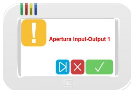
Una volta inserito il codice, possono essere notificate delle anomalie registrate dall'unità centrale (es.: linee aperte, assenza alimentazioni, linee escluse...). Normalmente queste visualizzazioni (se non gravi) non impediscono l'attivazione del sistema. Toccare OK ✓ per confermare (se vi sono più notifiche si passa alla prossima) oppure NO ✗ per annullare l'attivazione del sistema. Toccare SKIP ► per saltare tutte le visualizzazioni e attivare il sistema.
