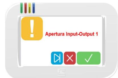
Una volta inserito il codice, possono essere notificate delle anomalie registrate dall'unità centrale.
