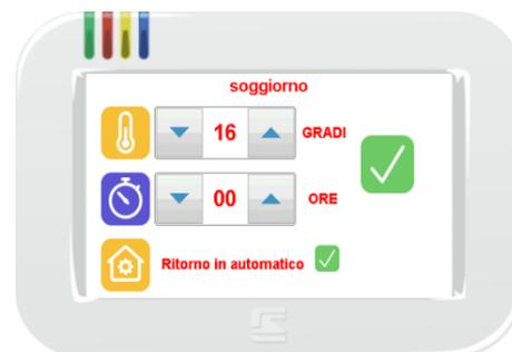
Impostare la temperatura desiderata (GRADI) e il numero di ore per cui la si vuole mantenere (ORE) quindi toccare il tasto OK ✓. Se non si specifica un numero di ore verrà utilizzato quello pre-impostato (*chiedere all'installatore del sistema*).
