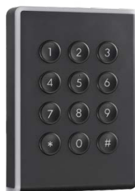
SF-AC1101KEM-WR * Lettore Pin o Scheda EM Per esterni IP65
