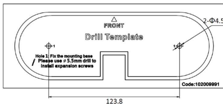
Realizzati i fori, fissare al tetto la base della camera, tenendo presente la posizione dell'indicatore "FRONT" come mostrato in figura:
