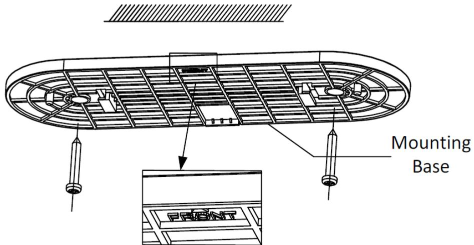
Per concludere l'installazione, fare coincidere la posizione dell'indicatore FRONT della base con quello della camera:
