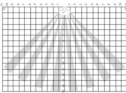
Vista dall'alto della zona a infrarossi per una lente 15 metri con posizionamento centrale.
