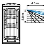
› È possibile limitare la distanza di rilevazione, applicando le maschere adesive appropriate.
