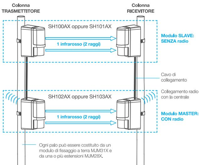
**Accessori per il fissaggio delle barriere a medio raggio**
