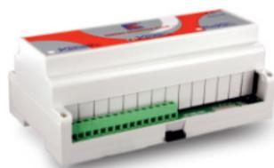
Scheda di espansione 10 uscite a relè + connessione RELEXP (6 uscite aggiuntive)
