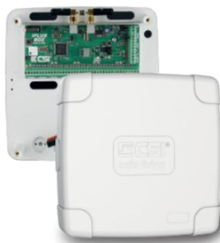
Scheda di espansione porte IO, per sistema Infinite.
