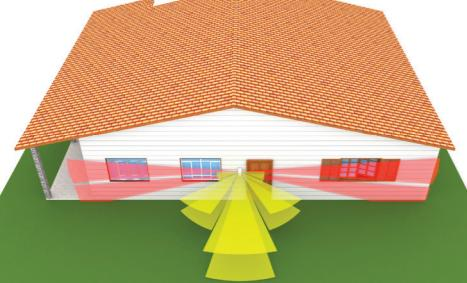
Una doppia barriera IR ai lati del sensore crea una protezione di porte e finestre disposte sul fronte di un edificio per una lunghezza di 12 + 12 metri. La rilevazione laterale su ciascun lato è affidata alla combinazione di due testine IR con logica AND, che generano due zone di rivelazione a tenda con apertura 10° e portata fino a 12 metri ciascuna.
