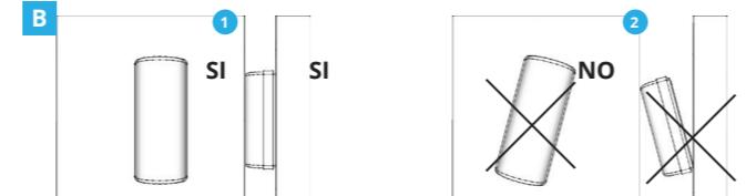
Montare il sensore verticalmente, senza inclinazione frontale e laterale (fig. B-1). Se il sensore è montato con una inclinazione rispetto al terreno, la rilevazione viene alterata (fig. B-2).
